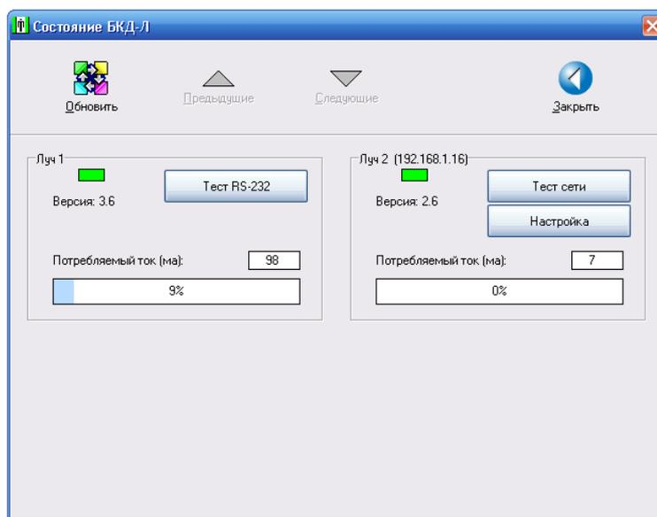
Рисунок – Окно «Состояние БКД» - оба луча исправны
